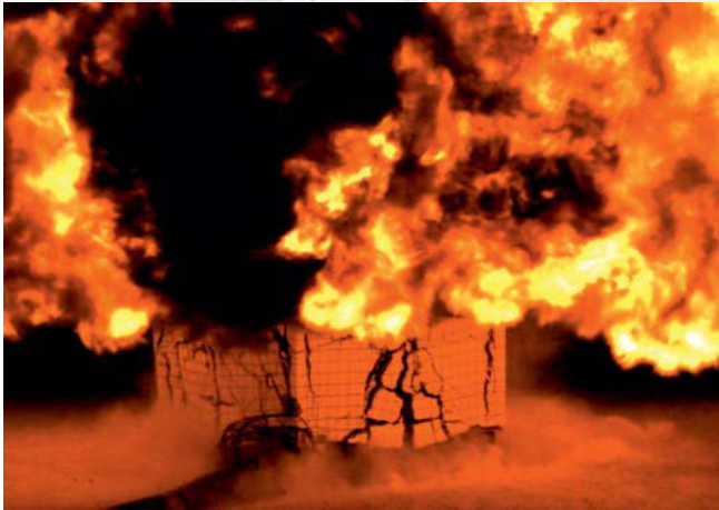
Sprengversuch mit Kontaktdetonation an einem Betonprüfkörper (100 cm x 100 cm x 50 cm)
